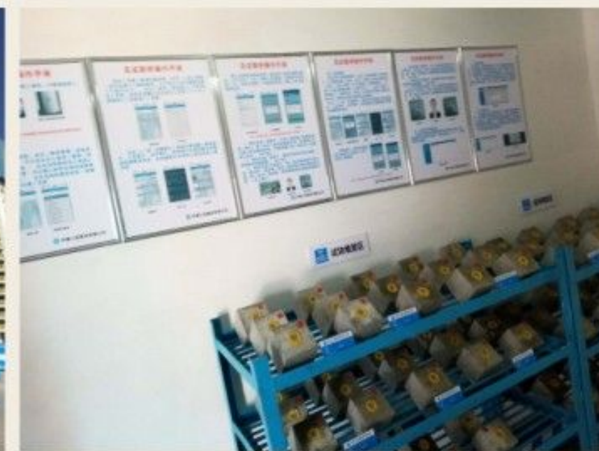
现场标养室设置
